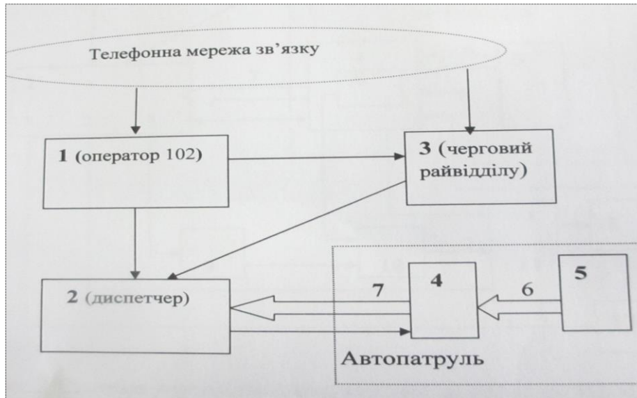
Рис.1. Система управління нарядами патрульної служби з відео каналами. Де: 1- оператор 102, 2- диспетчер, 3- черговий районного відділу поліції,, 4- планшет мобільного патрульного наряду з системою супутникового GPS-позиціонування, 5 - особистий відеореєстратор патрульного, 6 та 7- перший та другий канали передачі відео потоку.
