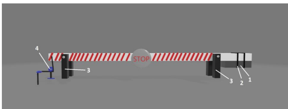
Рис. 2. Дистанційно керований шлагбаум 1 – вантаж; 2 – кріплення вантажу; 3 – стійка; 4 – блок.
