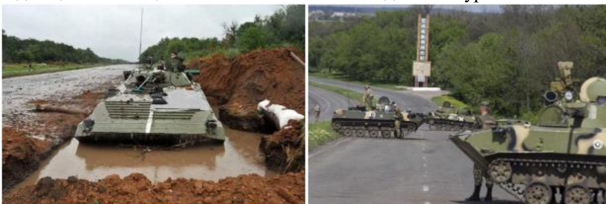
Фото 2. Погано облаштовані позиції для бойової техніки без урахування відведення води:
