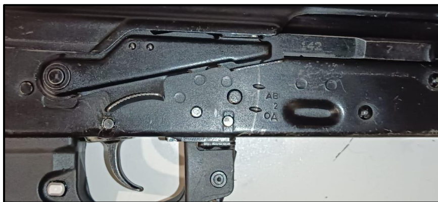
Рис. 2. Зображення перемикача вогню на ствольній коробці 5,45-мм автомата Калашникова АК-12
