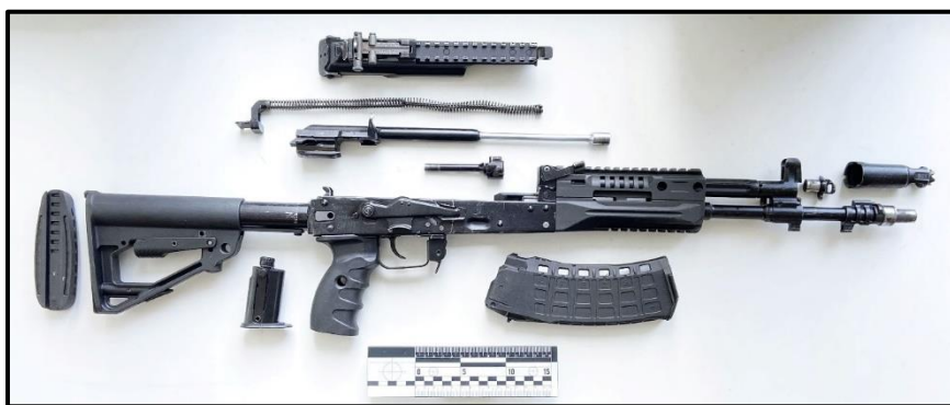
Рис 1. 5,45-мм автомат Калашникова АК-12 та його основні частини
