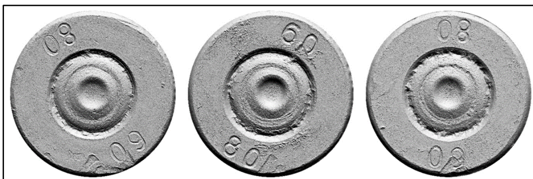
Рис. 8. Збільшене зображення слідів на гільзах патронів, стріляних з 5,45-мм автомата АК-12.
