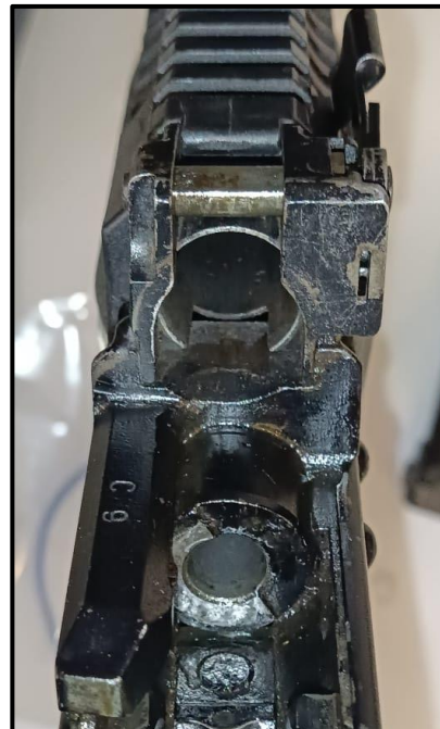
Рис. 7. Кульний вхід у ствол 5,45-мм автомата Калашникова АК-12
