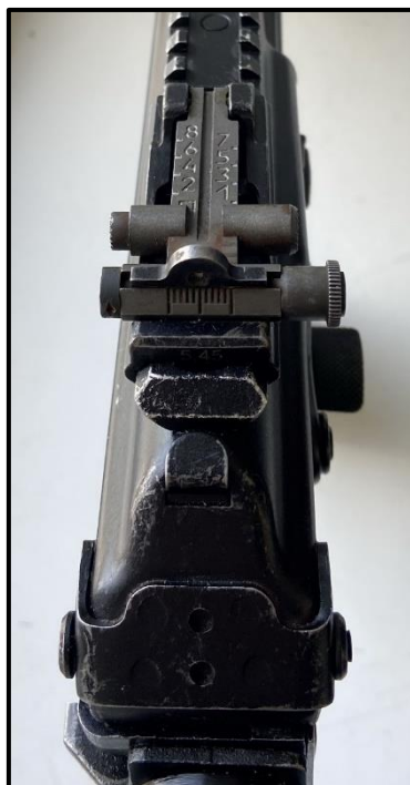
Рис. 4. Прицільні пристосування 5,45-мм автомата АК-12
