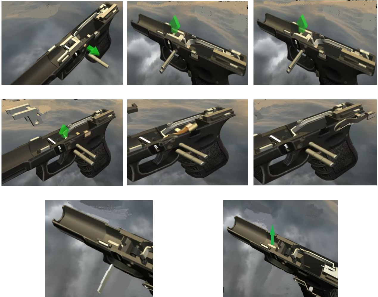
Рис. 78. Порядок дій при від'єднанні замикаючого блоку та затворної затримки пістолета GLOCK
