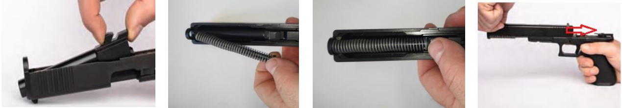
Рис. 31. Порядок дій при збиранні пістолета GLOCK
