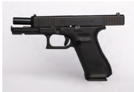
Рис. 20. Положення затвора після використання останнього патрона
