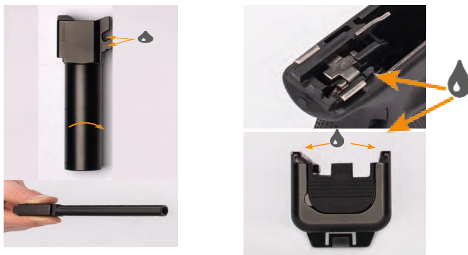
Рис. 27. Порядок дій при розбиранні пістолета GLOCK
