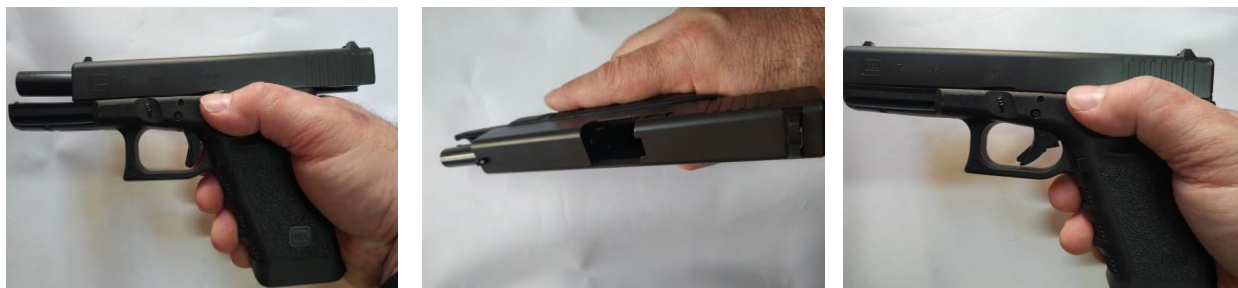
Рис. 74. Порядок дій при перевірці патрона в патроннику пістолета GLOCK
