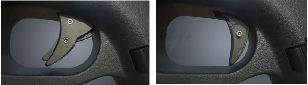
Рис. 21. Переднє та заднє положення гачка
