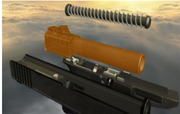
Рис. 76. Порядок дій при розбиранні затвора пістолета GLOCK
