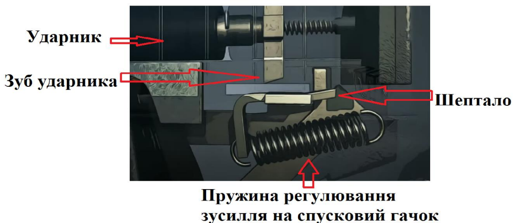
Рис. 8. Ударно-спусковий механізм пістолета GLOCK 17 (УСМ)
