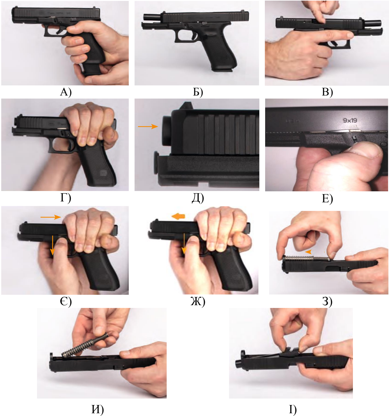
Рис. 23. Порядок дій при розбиранні пістолета GLOCK
