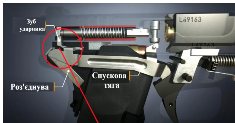
Рис. 11. Будова протиударного механізму
