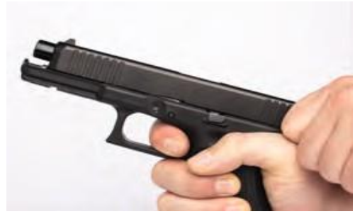
Рис. 33. Перевірка на повернення спускового гачка
