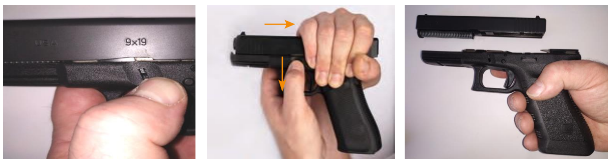
Рис. 75. Положення пальців рук при відведенні затвора пістолета GLOCK
