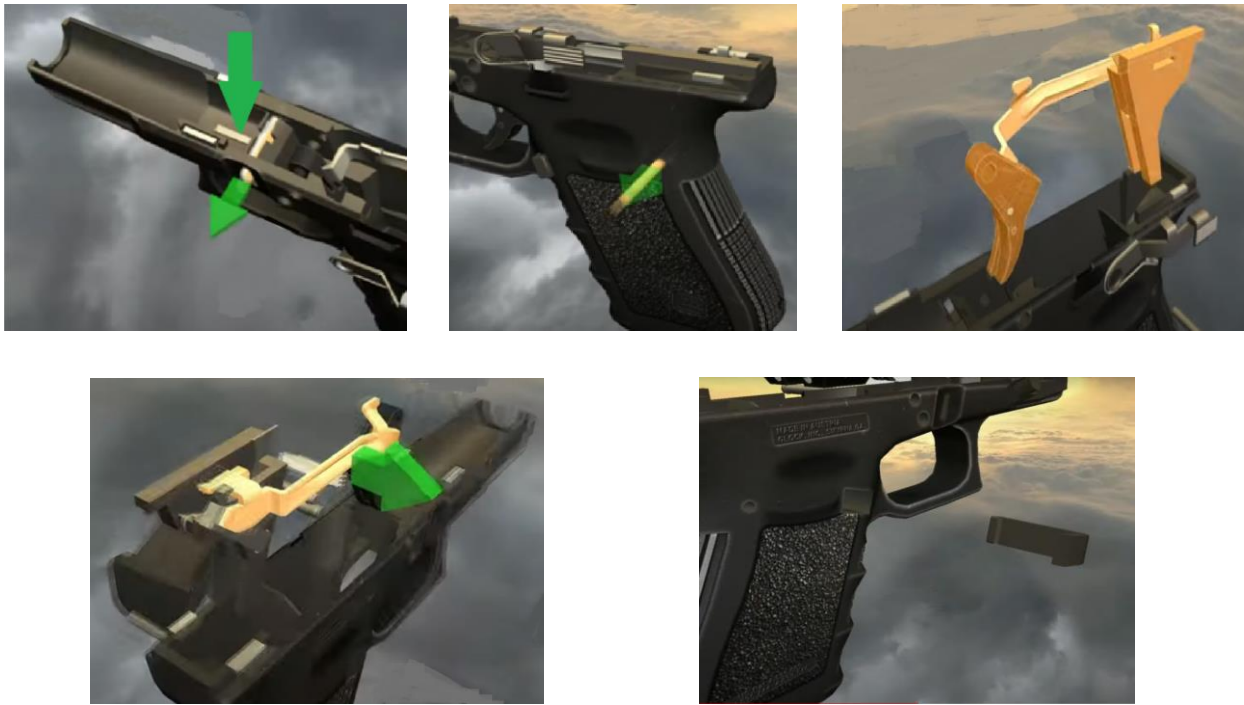
Рис. 79. Порядок дій при виштовхуванні осі блоку спускового механізму пістолета GLOCK
