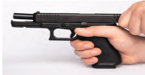
Рис. 34. Перевірка на повернення спускового гачка
