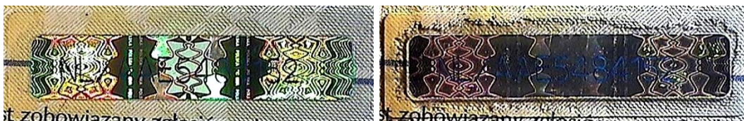
Рис. 11. Збільшене зображення голографічної стрічки (під різними кутами освітлення)
