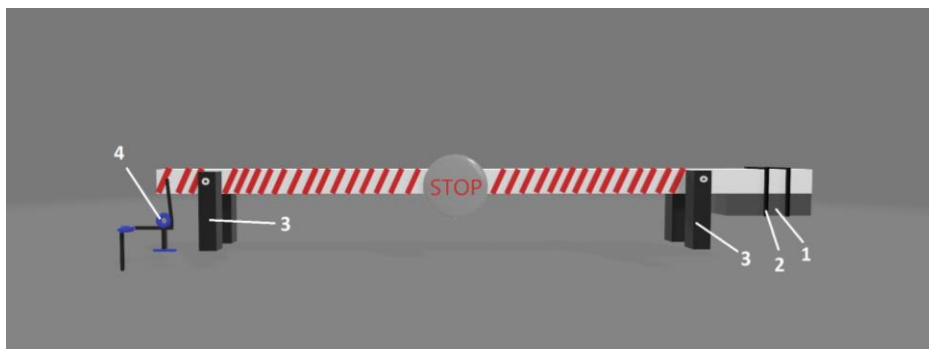
Рис. 2. Дистанційно керований шлагбаум 1 – вантаж; 2 – кріплення вантажу; 3 – стійка; 4 – блок.
