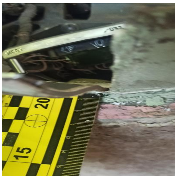
Рис. 2. Місце встановлення головного обтічника ракети 9-С-7760
