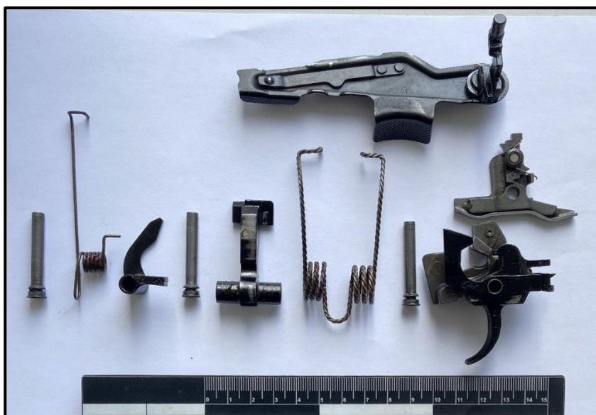
Рис. 3. Частина ударно-спускового механізму автомата АК-12
