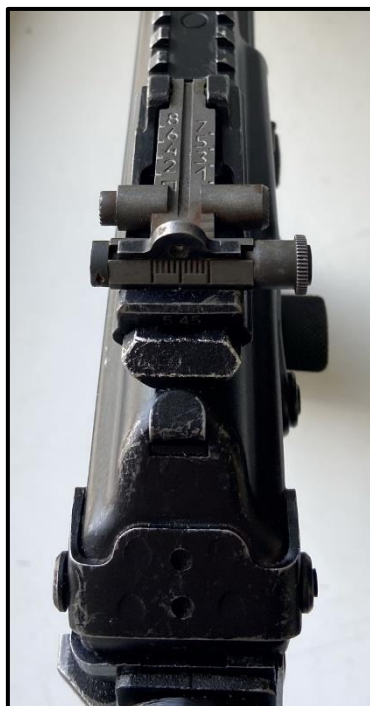
Рис. 4. Прицільні пристосування 5,45-мм автомата АК-12
