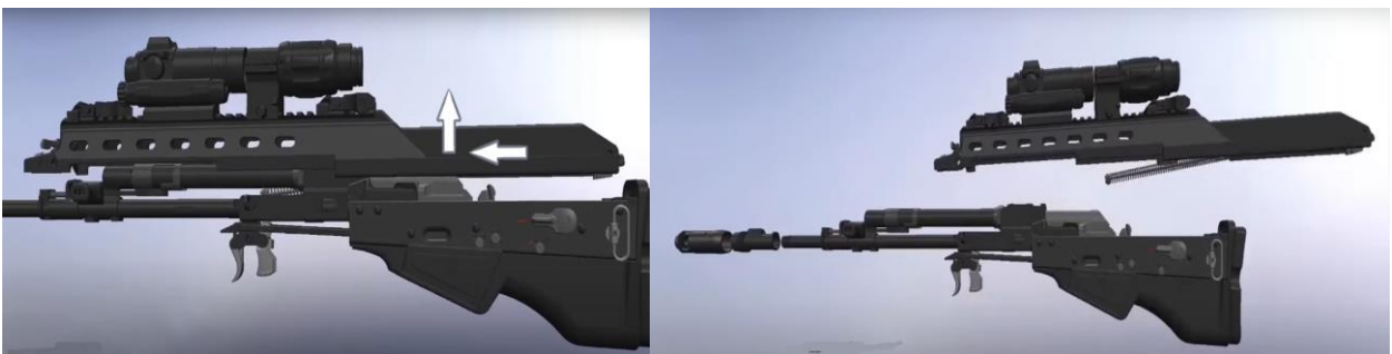
Рис. 8. Відокремлення кришки ствольної коробки автомата «Вулкан»
