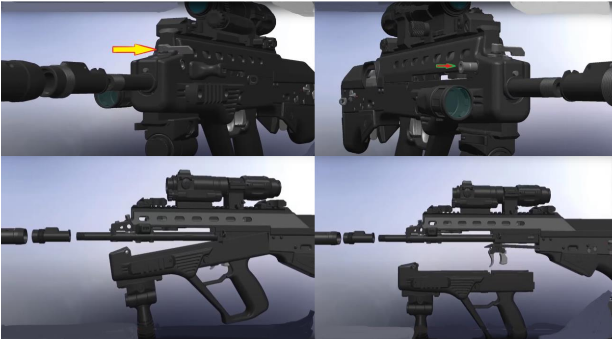
Рис. 7. Відокремлення вузла цівки автомата «Вулкан»
