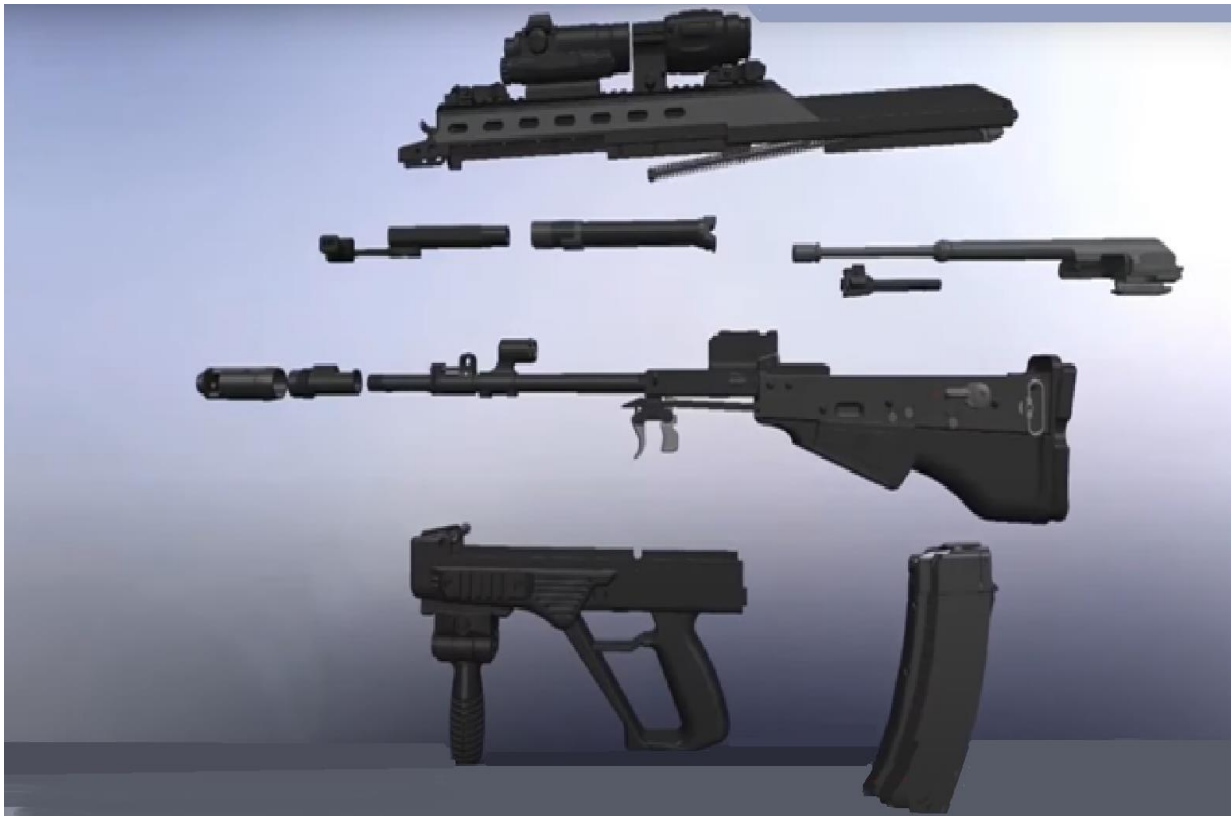
Рис. 13. Порядок збирання автомата «Вулкан»
