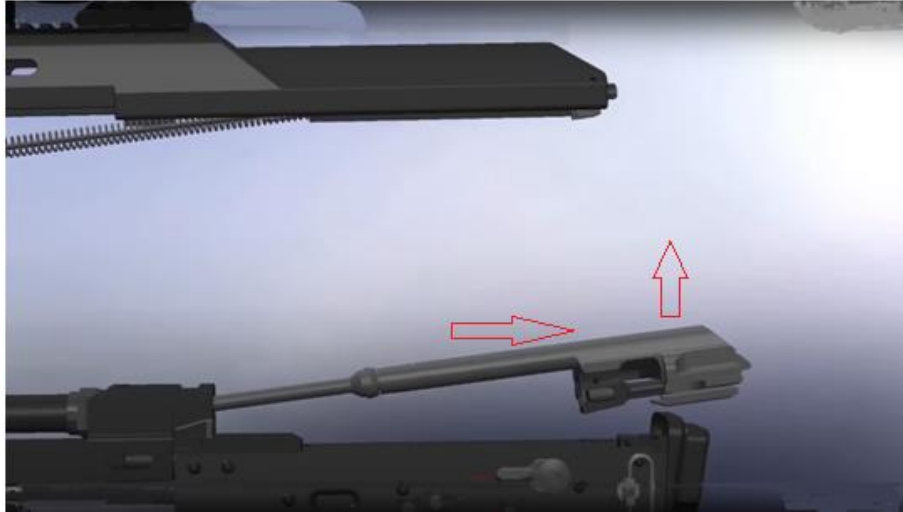
Рис. 9. Від'єднання затворної рами з газовим поршнем і затвором автомата «Вулкан»
