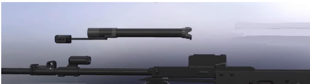
Рис. 11. Від'єднання газової трубки з руків'ям перезарядження автомата «Вулкан»
