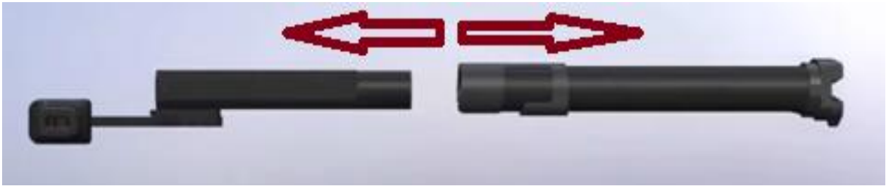
Рис. 12. Роз'єднання газової трубки з руків'ям перезарядження автомата «Вулкан»
