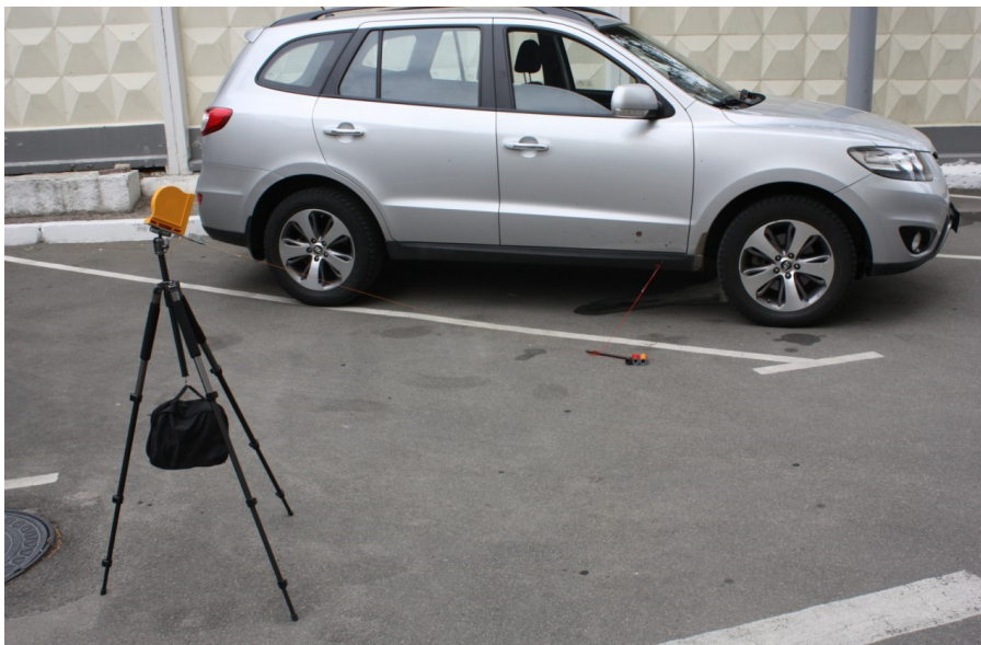
Рис. 1. Візування траєкторії підльоту снаряду, стріляного з гладкоствольної рушниці до автомобіля, під час слідчого експерименту (вертикальна площина)
