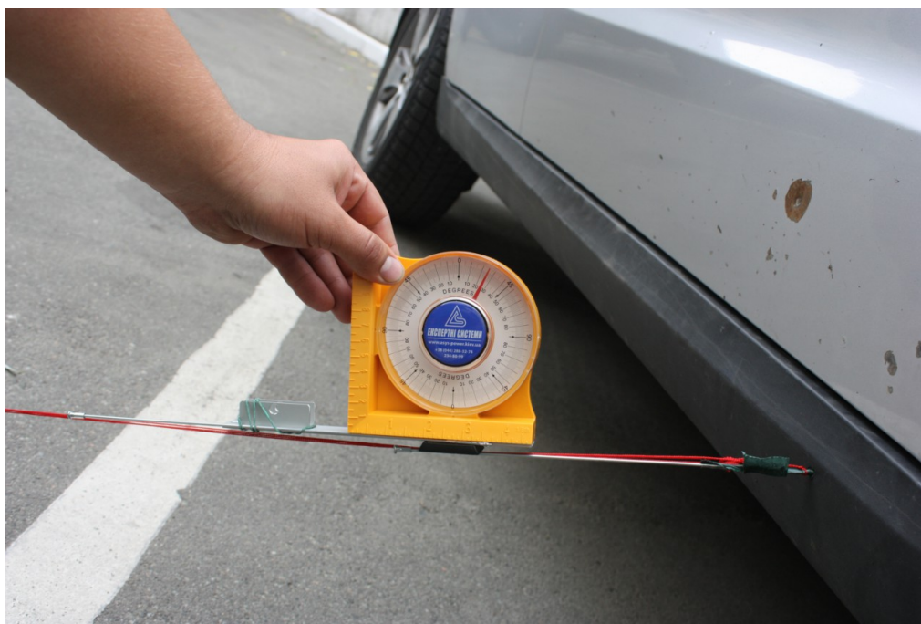
Рис. 3. Фіксування кута зустрічі снаряду з перешкодою (вертикальна площина)
