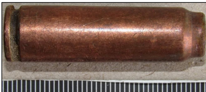
Зображення № 7. Донце та штовхач гільзи патрона СП-4 калібру 7,62x41 мм.
