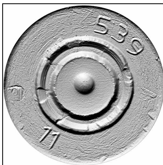
Зображення № 8. Сліди від частин зброї на гільзі патрона СП-4 калібру 7,62x41 мм.
