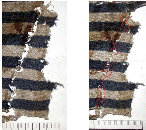
Зображення 1, 2. Неповне та повне суміщення пошкоджених країв фуфайки та фрагмента тканини, вилученого з автомобіля.
