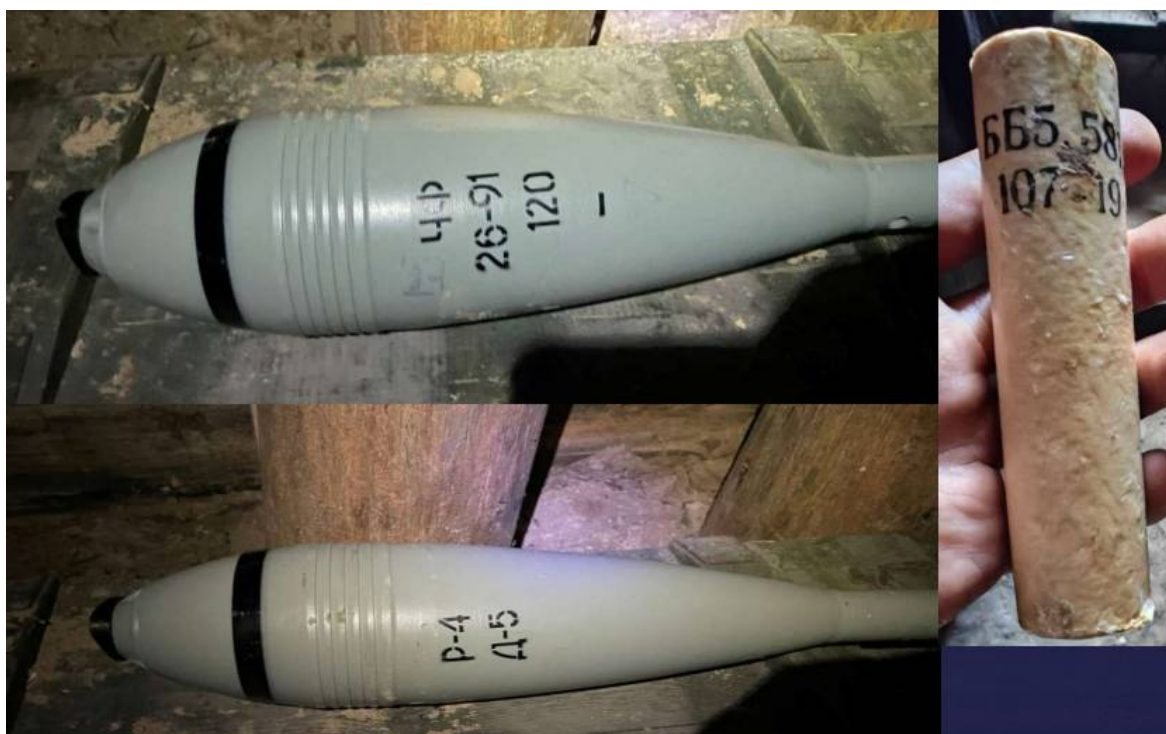
Рис. 166. 120-мм мінометна міна Д-5, димова
