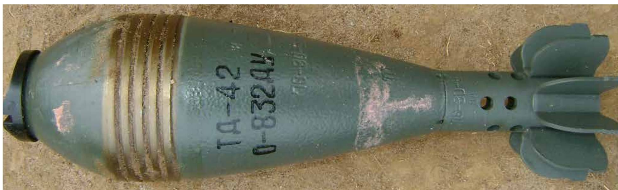
Рис. 148. 82-мм мінометна міна О-832-ДУ
