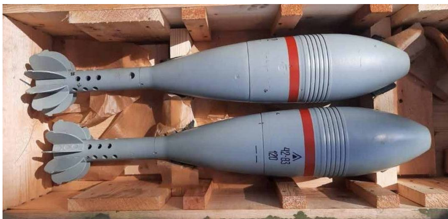
Рис. 171. 120-мм мінометна міна 3В34, запалювальна
