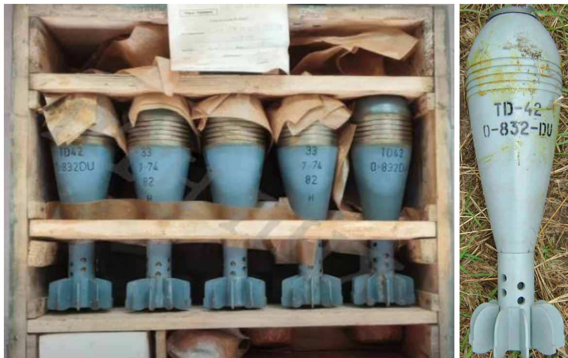
Рис. 153. 82-мм мінометний постріл O-832DU 14
