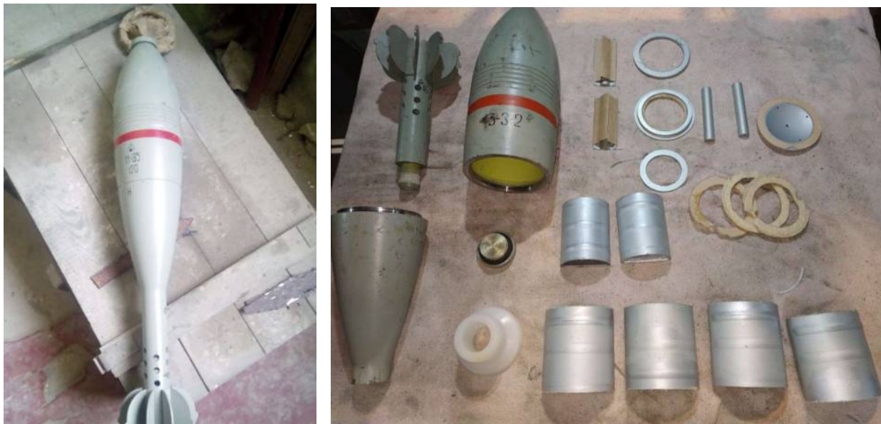
Рис. 165. 120-мм мінометна міна 3-3-2, запалювальна
