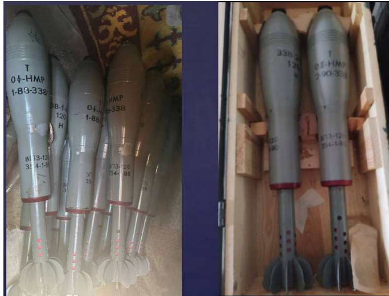
Рис. 172. 120-мм мінометна міна ОФ-НМР
