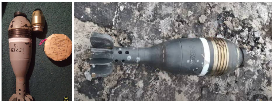
Рис. 159. Освітлювальна 82-мм мінометна міна С-832С
