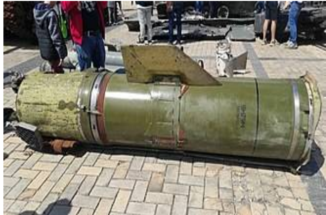
Рис. 249. Двигун від Точки-У
