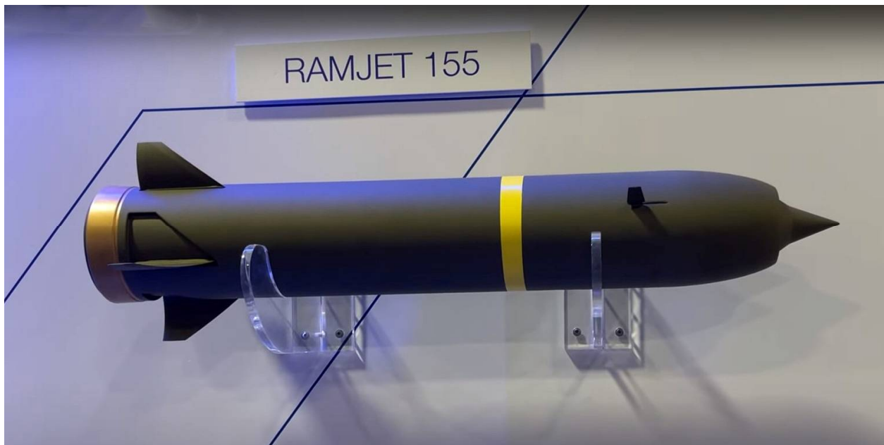
Рис. 176. Ramjet 155 – артилерійський снаряд, розроблений для підвищення дальності та точності стрільби з 155-мм гаубиць
