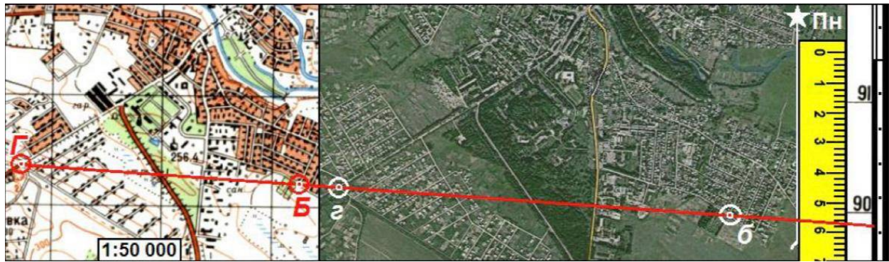
Рис. 43. Нанесення істинного і магнітного меридіана на аерознімок
