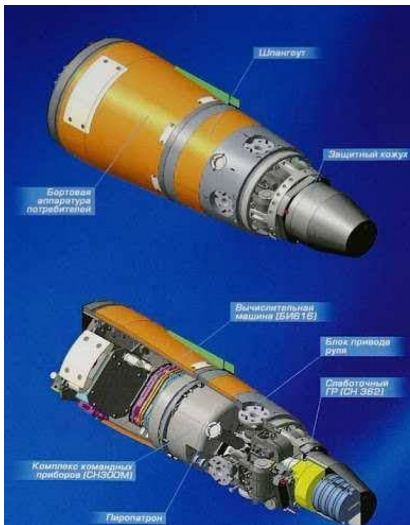
Рис. 1.25. Блок 9Б706.01.000 «Торнадо-С»
