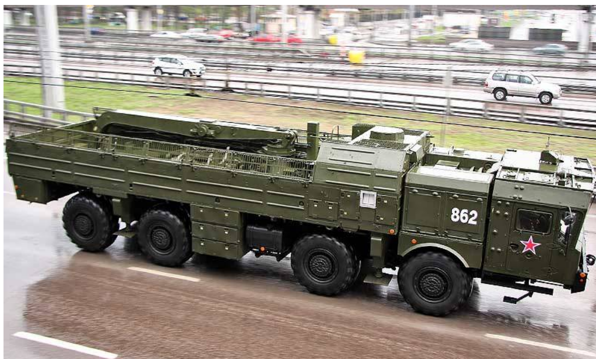
Рис. 1.2. Транспортно-заряджаюча машина (9Т250)
