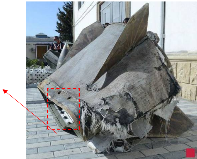
Зображення 4.285. Хвостова частина 9М723 з джерела [5]
