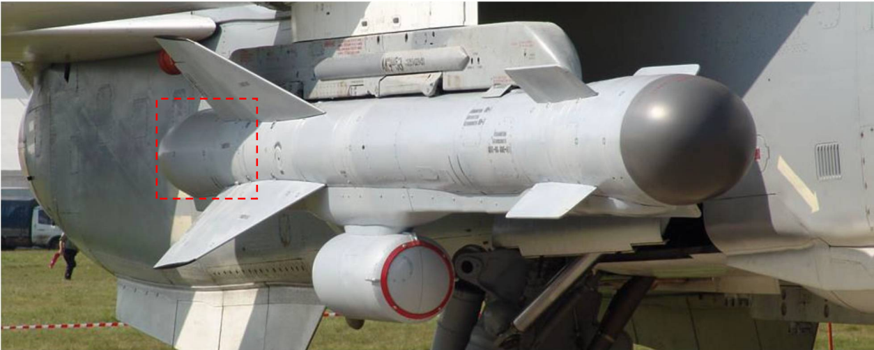
Зображення 4.203. Місцезоташування об'єкта № 1 на крилатій ракеті X-59МК [6]
