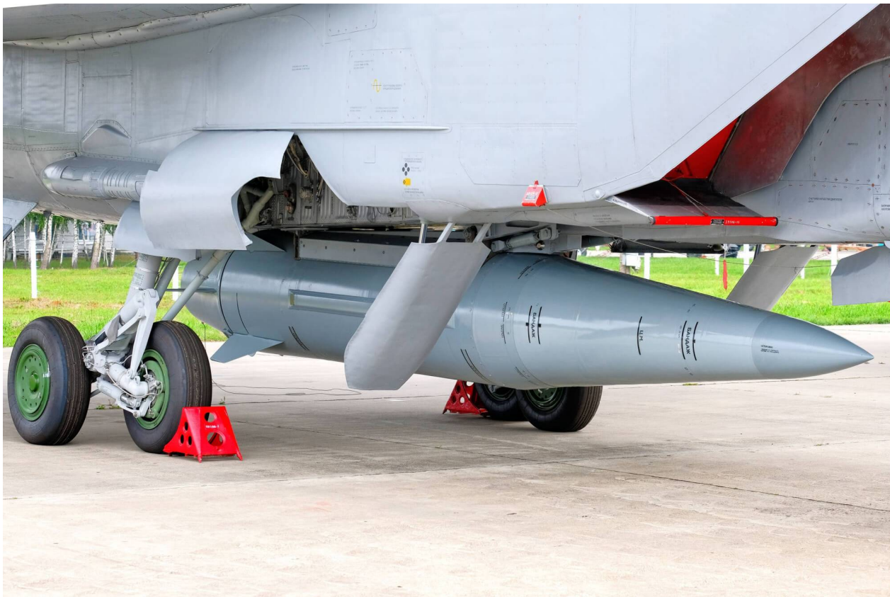
Рис. 1.8. Ракета 9-С-7760 на підвісці МіГ-31К
