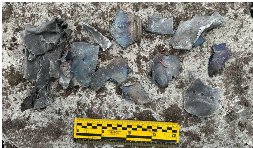
Зображення 4.204. Уламки KN-23/KN-24 з джерела [15]
