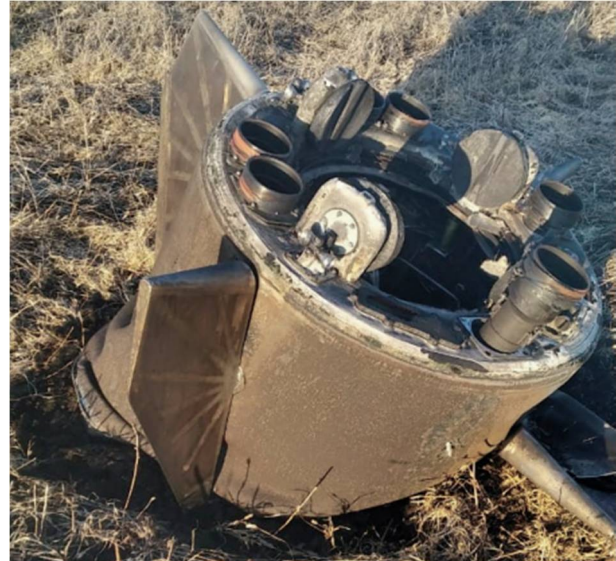
Зображення 4.150. Хвостова частина ракети 9М723 з джерела [6]
