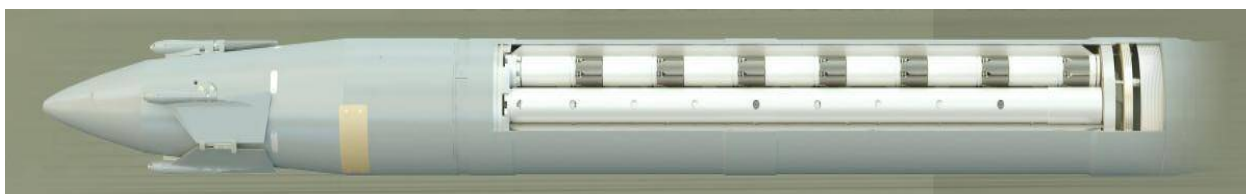
Рис. 1.22. Вигляд головної частини керованого реактивного снаряда 9М549
