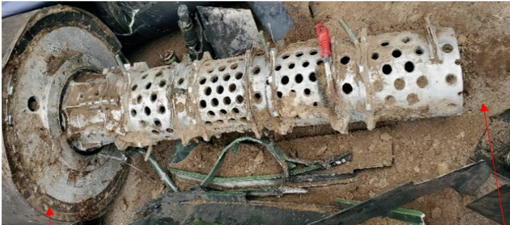
Зображення 4.142. Перфорована труба ракети 9М723 з джерела [6]
