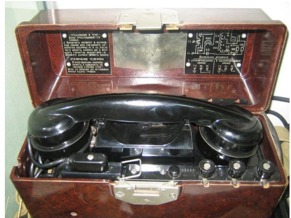
Рис. 7.1. Військово-польовий телефонний апарат: а – ТА-57; б – ТАВ-43
