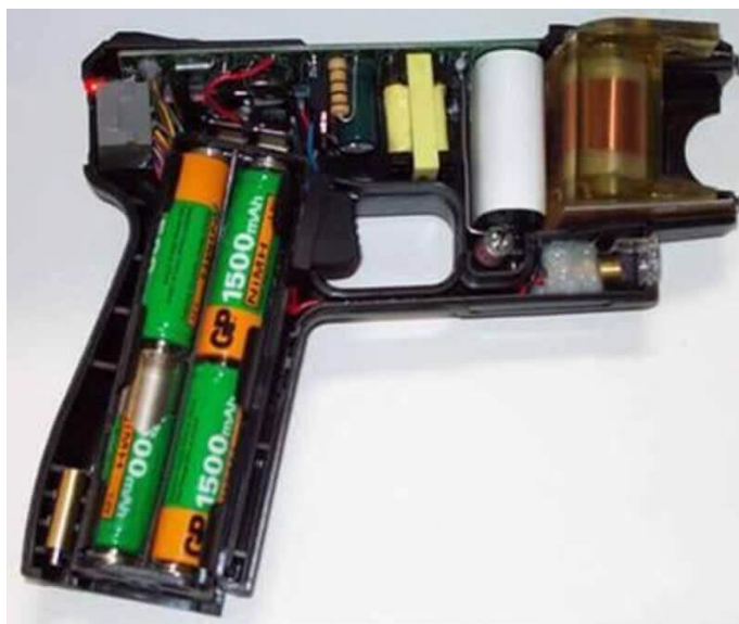
Рис. 5.13. Складові частини електрошокового пристрою
