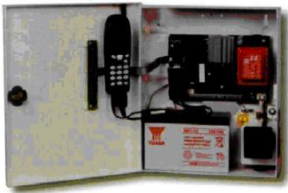
Рис. 6.3. Зовнішній вигляд ППК «Оріон 4Т»: а– внутрішня будова; б –зовнішній вигляд
