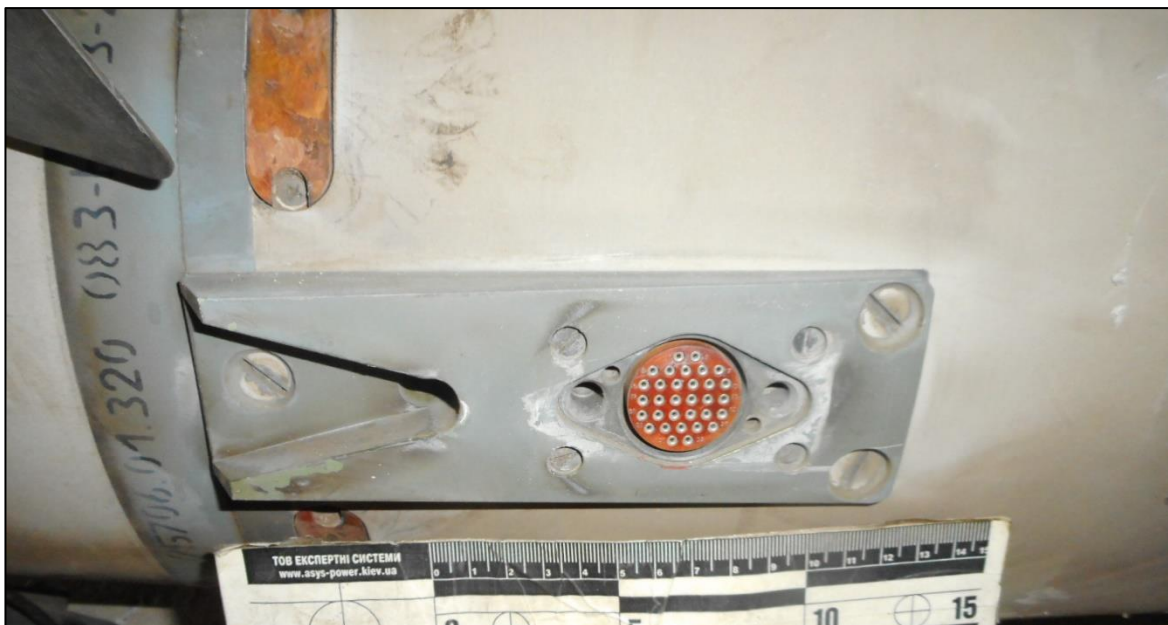
Зображення 1.6. Загальний вигляд отворів, схожих на штепсельний роз'єм на боковій поверхні одного з групи об'єктів № 1
