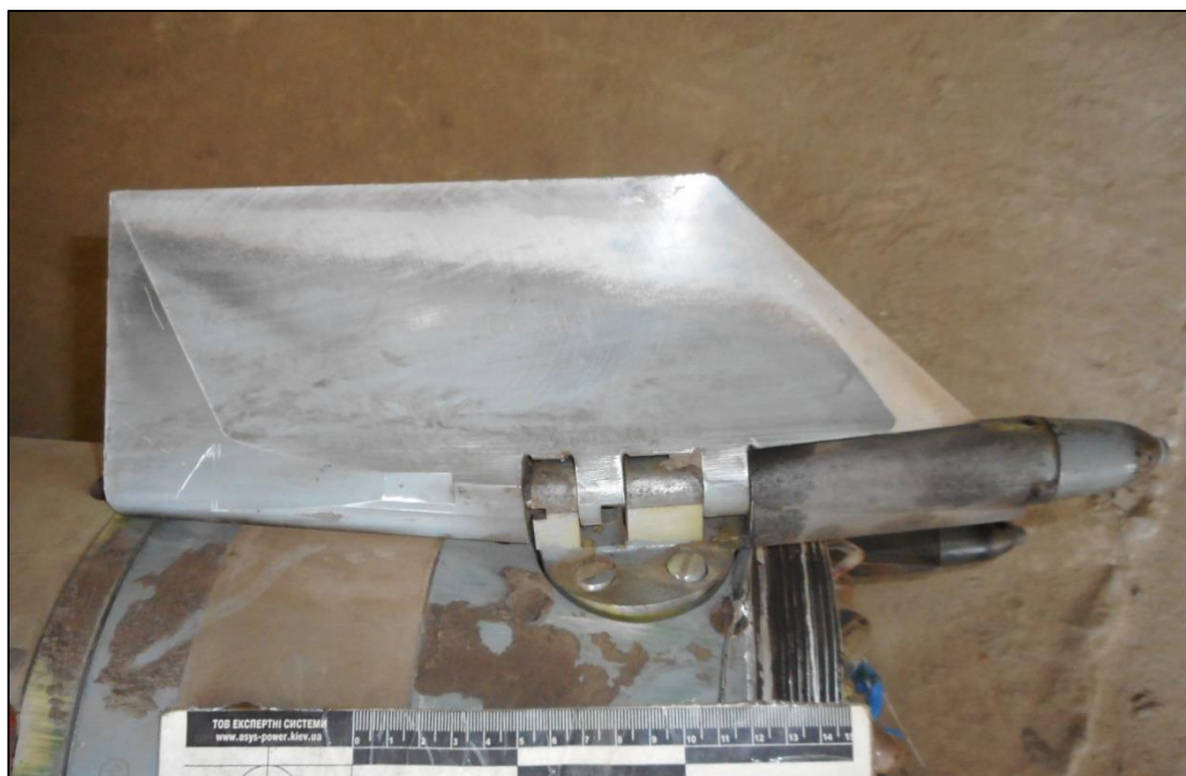
Зображення 1.7. Загальний вигляд рухомого кронштейна (оперення) на боковій поверхні одного з групи об'єктів № 1
