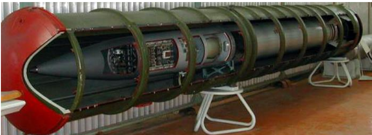
Зображення 8. Вигляд ЗКР 5В55 у транспортно-пусковому контейнері
