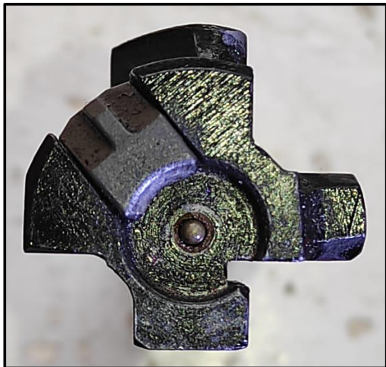
Рис. 6. Збільшене зображення переднього зрізу чашки затвору 5,45-мм автомата АК-12 зі слідоутворюючими частинами
